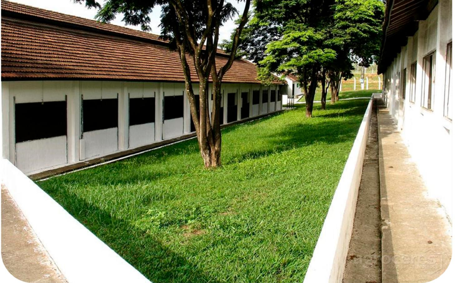
**Figura 8** – Árvores e grama entre galpões. As árvores e a grama melhoram o sombreamento e a absorção dos raios solares, além de proporcionar a entrada de ar mais fresco no galpão.
